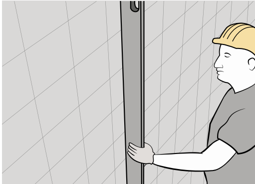
Contrôle de la planéité du support existant
