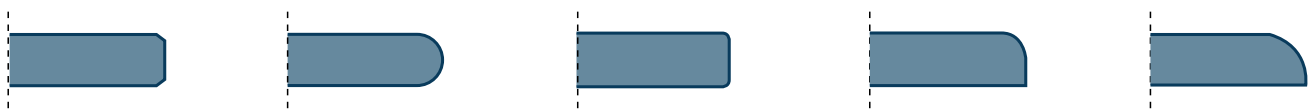
Straight bevelled edge Rounded bevelled edge Bullnose edge Half bullnose edge Beading edge
