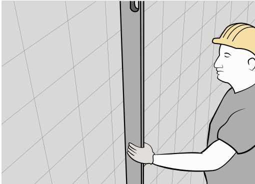
Comprobar la planaridad del sustrato existente
