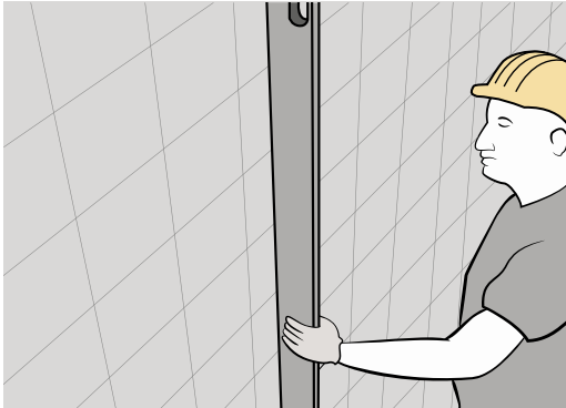
Comprobar la planaridad del sustrato existente
